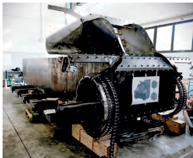
Lo stato dei lavori con alcune componenti degli organi che daranno il moto alla replica del carro armato Fiat 2000
